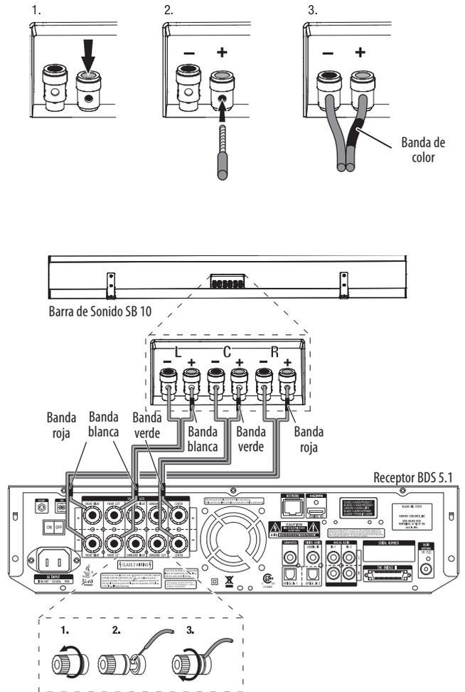
**IMPORTANTE:** Asegúrese de que los cables pelados (+) y (-) no se toquen entre sí ni al otro terminal. Al tocarse, los cables podrían causar un corto circuito que podría dañar su receptor o amplificador.
