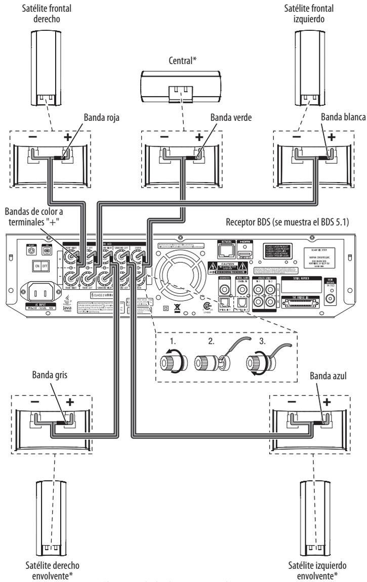
**IMPORTANTE:** Asegúrese de que los cables pelados (+) y (-) no se toquen entre sí ni al otro terminal. Al tocarse, los cables podrían causar un corto circuito que podría dañar el receptor.
